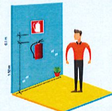
Señales de ubicación de equipo contra incendios
