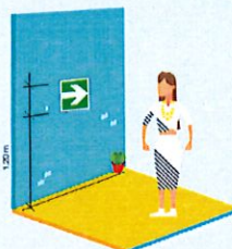
Colocación en paredes y pasillos
